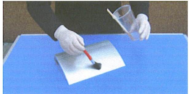
6. Harzmischung genügend dick-klebrig auf die Oberfläche auftragen...
