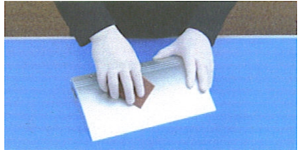
2. Untergrund des Bauteiles mit feinem Schleifpapier aufrauen...
